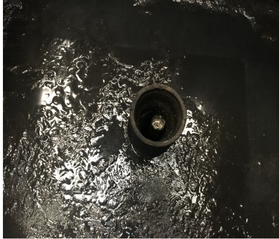
Foto 4. Tubería revestimiento y producción
